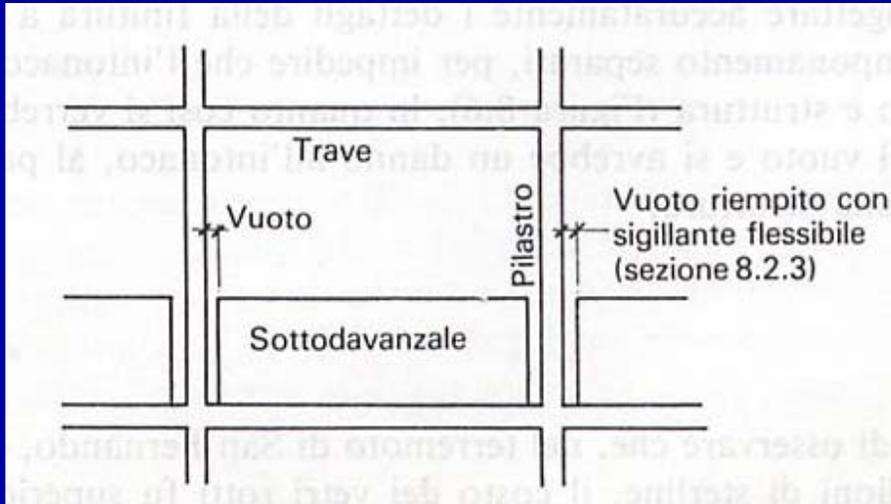
Particolare del telaio esterno, illustrante la separazione del parapetto dal pilastro per evitare interazioni non desiderate
