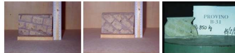
Risultati delle prove di schiacciamento su muretti a filari inclinati
