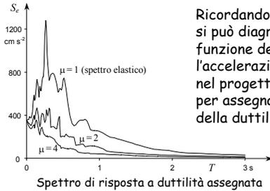
Ricordando che  $F = m a$ , si può diagrammare in funzione del periodo l'accelerazione da usare nel progetto, per assegnati valori della duttilità  $\mu$
