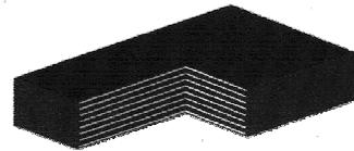
Gli appoggi in gomma sopportano carichi e deformazioni simultanei in ogni direzione e consentono rotazioni attorno ad un qualsiasi asse.
