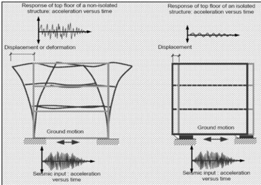
Spostamenti e deformazioni di edifici a base fissa e isolata
