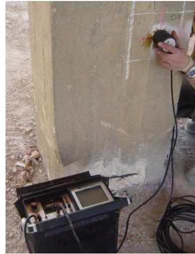
Fasi di prova per il rilievo della velocità V_{\text{situ}}
