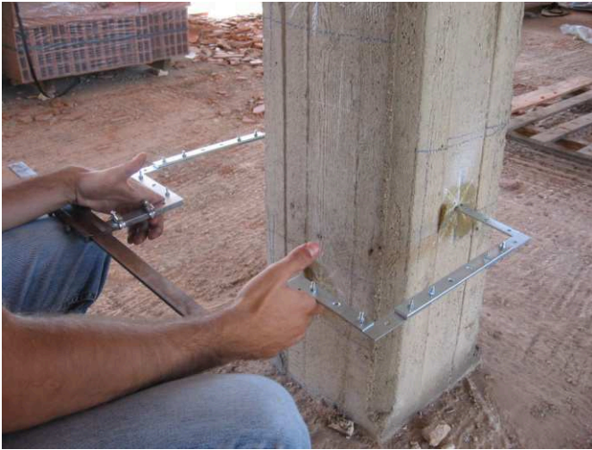
Fasi di prova per il rilievo della velocità V_{\text{situ}}
