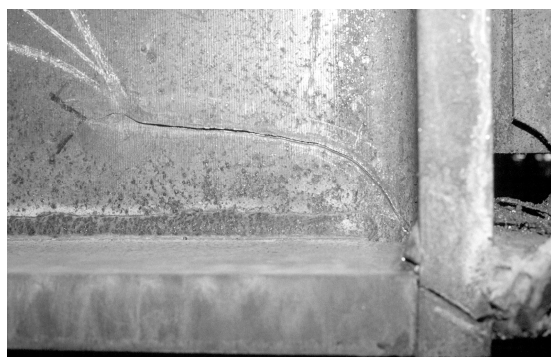
c) frattura lungo la sezione della colonna
