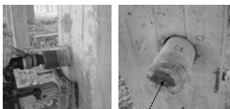
Fasi di estrazione di un campione
