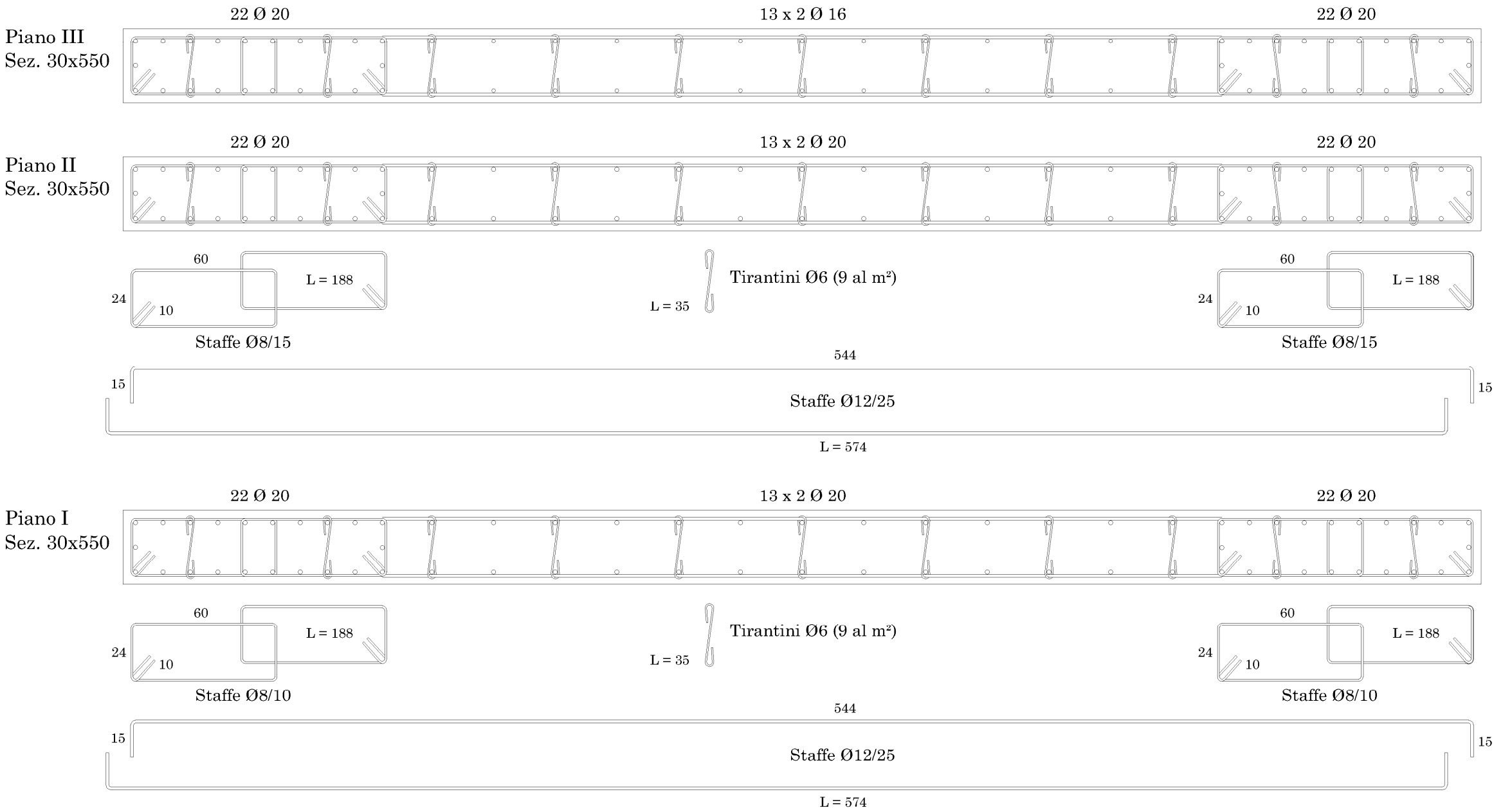
Segue Figura 35 – Disegno esecutivo delle sezioni trasversali ad ogni piano della parete 33 per il progetto a bassa duttilità
