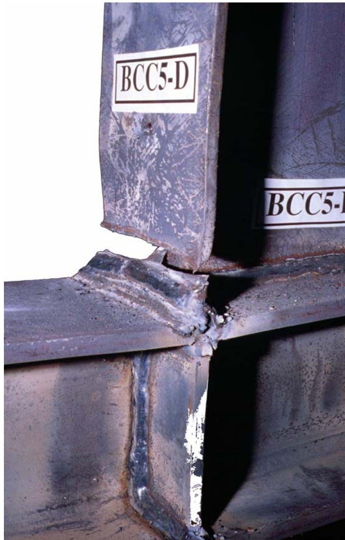
Figura 4-26: Particolare della frattura del provino BCC5-D.
