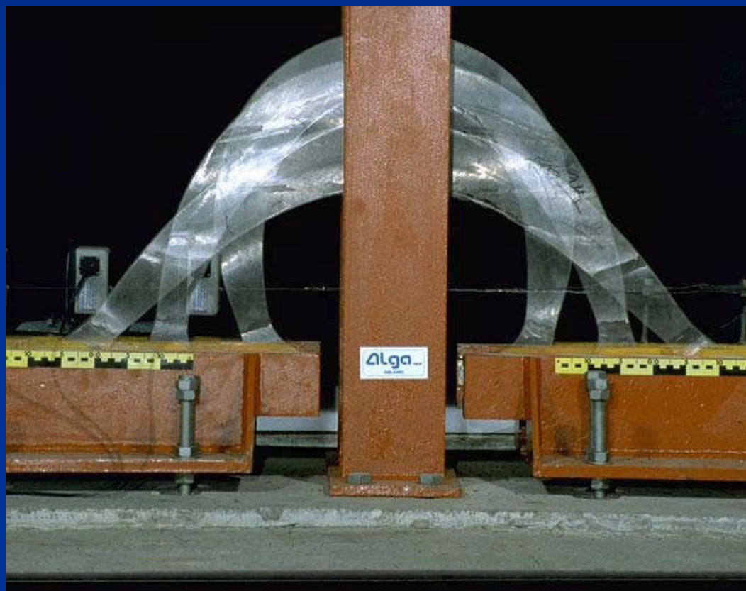
Dissipatore isteretico (tipo C)
