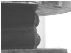
Effetto di vincolo esercitato dalle piastre in acciaio sulla gomma dei dispositivi di isolamento
