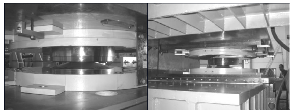
Foto di isolatori a scorrimento a doppia superficie sferica
