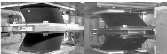
Prove di laboratorio di isolatore elastomerico
