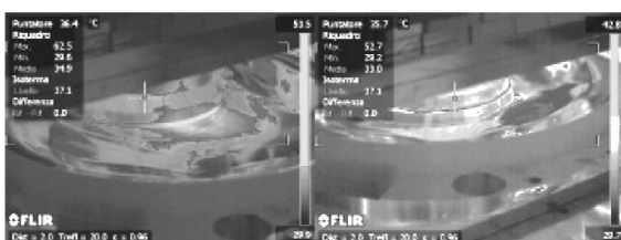
Termografia di isolatore a scorrimento a semplice superficie sferica
