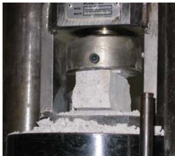
Resistenza a compressione delle malte
