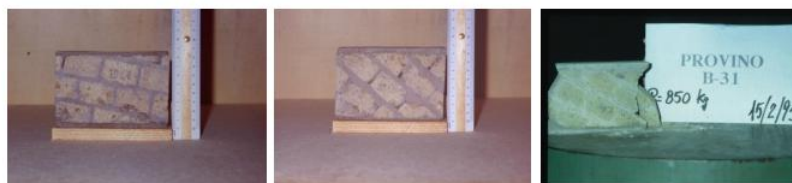
Risultati delle prove di schiacciamento su muretti a filari inclinati
