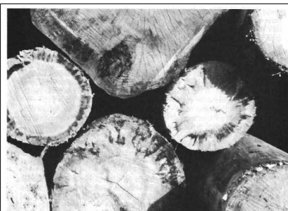
Fig. 1.54 Attacchi di funghi cromogeni su tronchi di Conifere da lungo tempo in deposito all'aperto. Si noti come gli attacchi siano prevalentemente limitati all'albero periferico (Foto Giordano, 1920).
