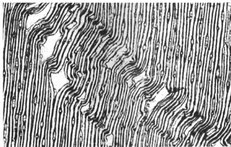
8 Microfotografia ( \times 35 ) dell'inizio di rottura per compressione assiale in un provino di Abete bianco (Foto Giordano, 1970).
