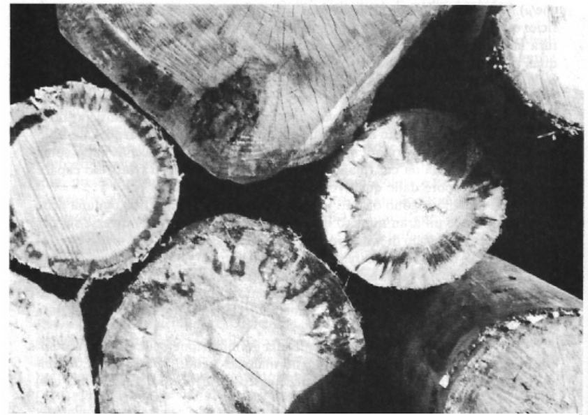
Fig. 1.54 Attacchi di funghi cromogeni su tronchi di Conifere da lungo tempo in deposito all'aperto. Si noti come gli attacchi siano prevalentemente limitati all'alburno periferico (Foto Giordano, 1990).
