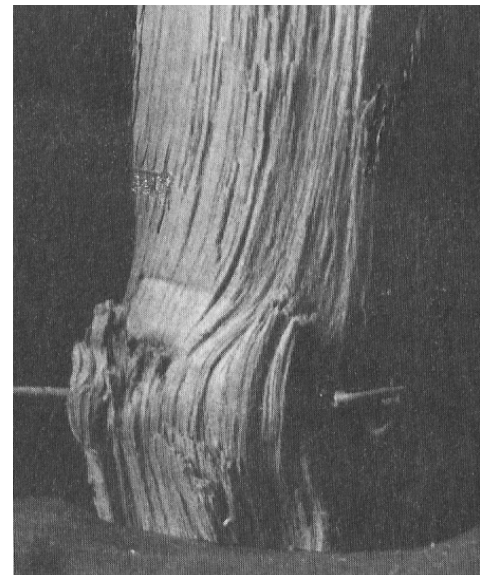
Fig. 1.47 Deviazione localizzata della fibratura derivante dall'infissione di un arpione metallico in un fusto di Frassino (Foto Giordano, 1991).
