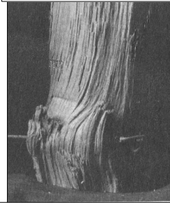
Fig. 1.47 Deviazione localizzata della fibratura derivante dall'infrissione di un arpione metallico in un fusto di Frassino (Foto Giordano, 1991).
