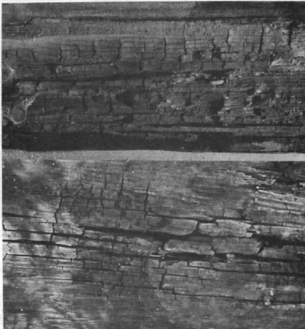
Fig. 1.57 Aspetto di legni di Conifere attaccati da funghi provocanti “carie a cubetti”. Materiali in tali condizioni devono essere assolutamente scartati da ogni impiego strutturale (Foto Giordano, 1975).
