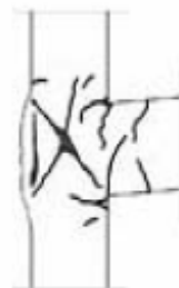
Fig. 3.24: Rottura a taglio del nodo d'angolo con formazione di fessura diagonale e svergolamento della barra longitudinale del pilastro, si evidenzia l'assenza di staffe nel nodo e nell'estremità superiore del pilastro (Foto P. Ricci e G.M. Verderame, Abruzzo 6/4/2009)
