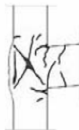
Fig. 3.25: Danneggiamento del nodo trave-pilastro a causa degli elevati sforzi assiali e di taglio (Sicilia 1990, Augusta)
