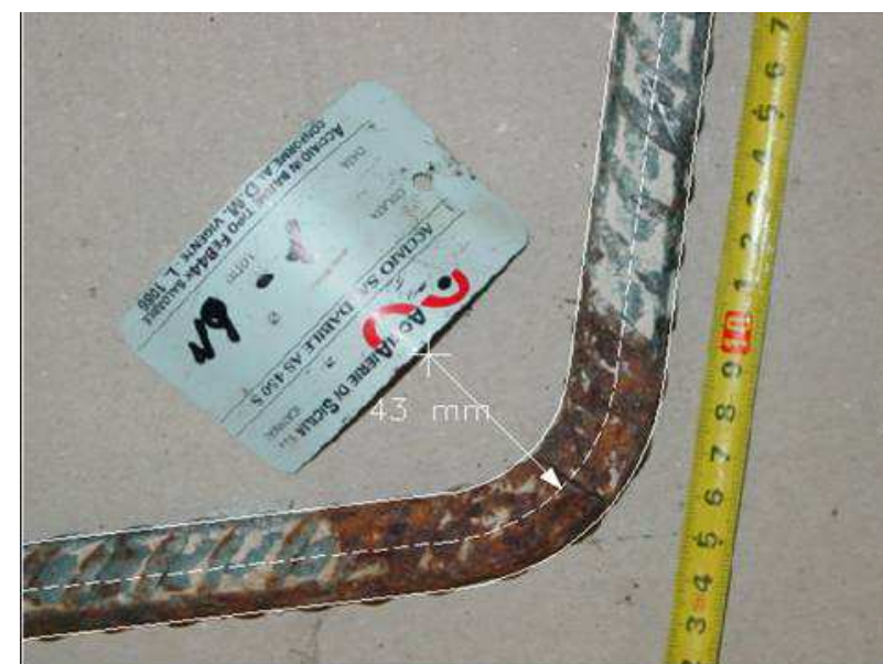
Rilievo dei raggi di curvatura
