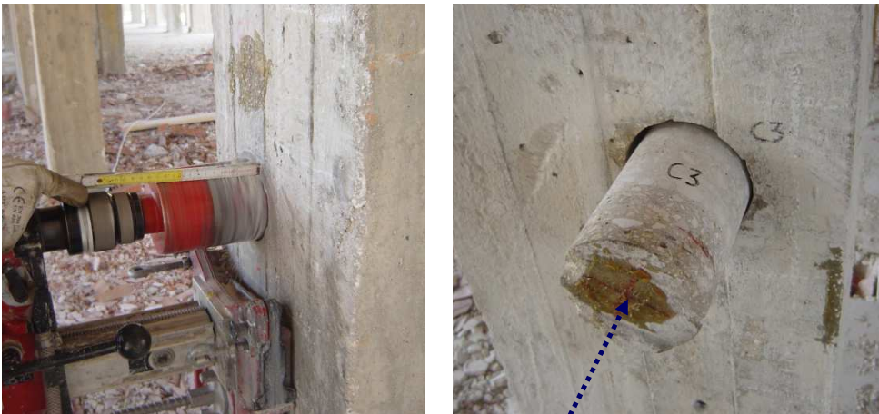
Fasi di estrazione di un campione
