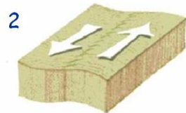
scorrimento impedito: deformazione con accumulo di energia
