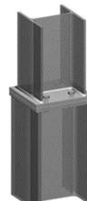
[2] Esempi di tipiche connessioni colonna-colonna
