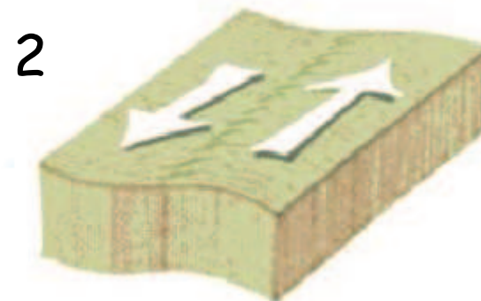
scorrimento impedito: deformazione con accumulo di energia
