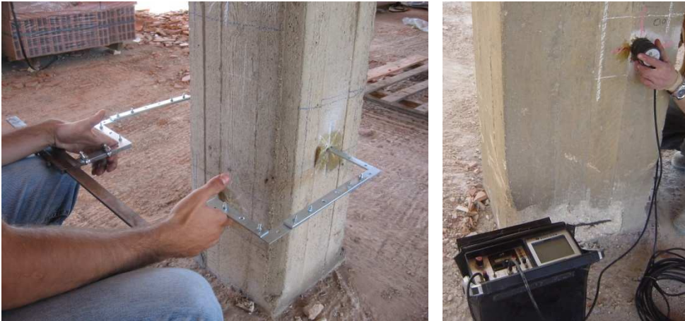
Fasi di prova per il rilievo della velocità V_{\text{situ}}
