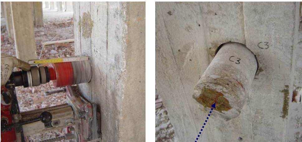
Fasi di estrazione di un campione
