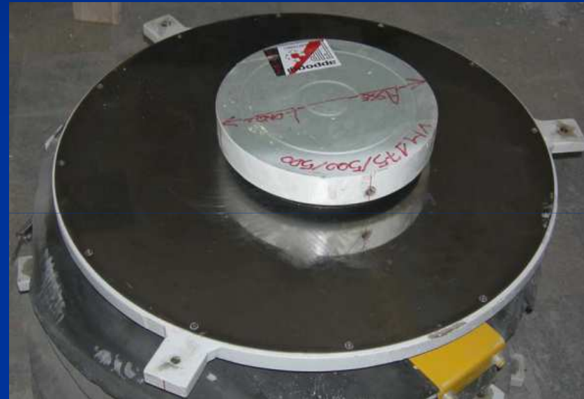
Isolatore a scorrimento a superficie piana
