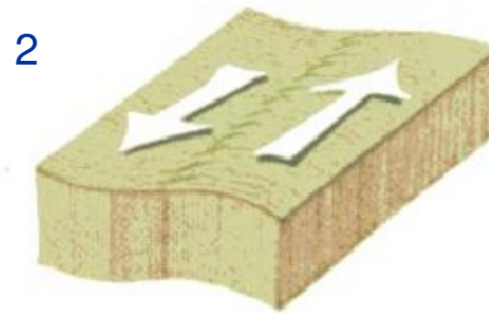
scorrimento impedito: deformazione con accumulo di energia
