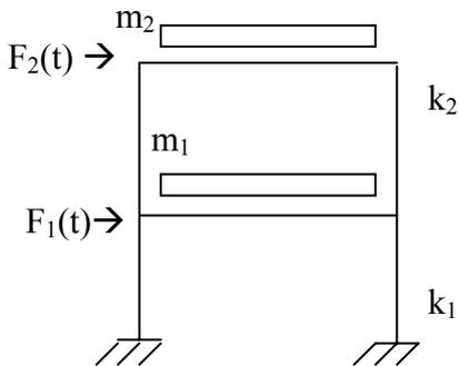
Lo schema in figura può essere idealizzato anche come un unico pilastro avente le masse concentrate a livello di ogni piano con l'intesa che sia possibile soltanto lo spostamento orizzontale di tali masse, per cui si avrà lo schema che segue:
