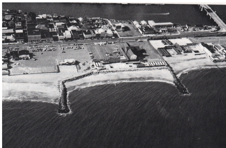
Figura 16.2. Esempio di realizzazione di pennelli.
