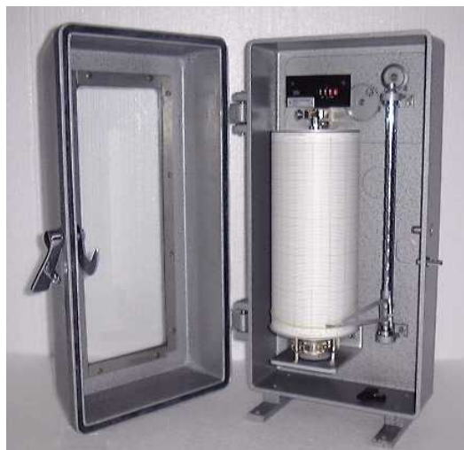
Figura 3.3. Sistema di registrazione su tamburo del mareografo SIAP ID5793.
