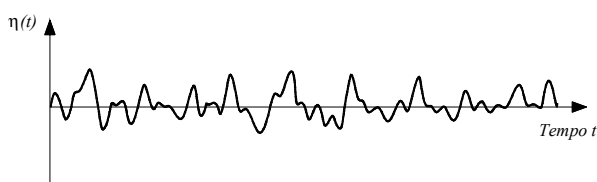
Figura 5.4. Esempio di segnale relativo alla registrazione della sopraelevazione del pelo libero in un punto.
