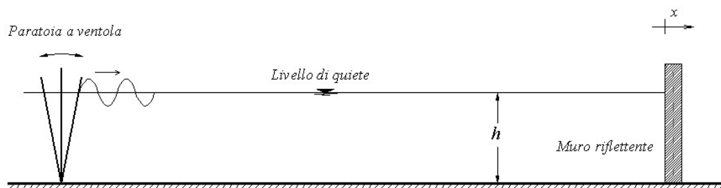
Figura 7.1. Schematizzazione del problema della riflessione di un'onda che incide su di un ostacolo verticale.
