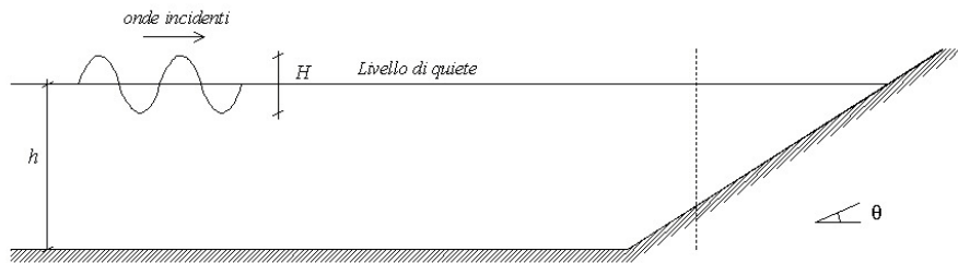
Figura 7.11. Schema adottato per lo studio della riflessione provocata da una parete impermeabile inclinata.
