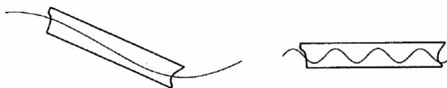
Figura X.14. Illustrazione degli effetti del periodo d'onda sui movimenti della nave.
