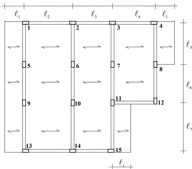
L'edificio, di cui a fianco è indicata schematicamente la carpenteria, ha sei piani (o, più precisamente, sei impalcati), con altezza di interpiano pari a 3.30 m (3.50 m al primo ordine). Le pareti perimetrali di tamponamento sono realizzate con una fodera di mattoni pieni ed una di mattoni forati. La struttura, in cemento armato, deve essere progettata con riferimento alle Norme tecniche per le Costruzioni.
