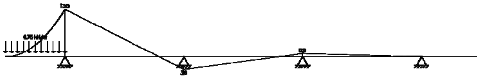
Figura 20: Diagramma del momento, massima sollecitazione sezione AA
