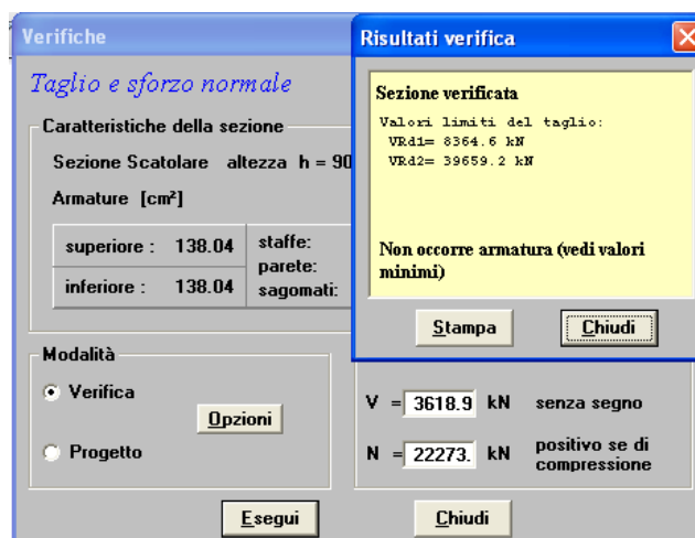
Figura 102: taglio resistente della pila
