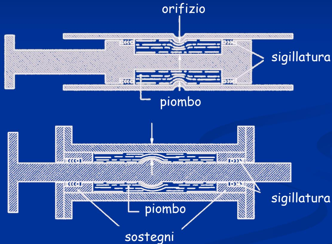
Dissipatore ad estrusione di piombo
