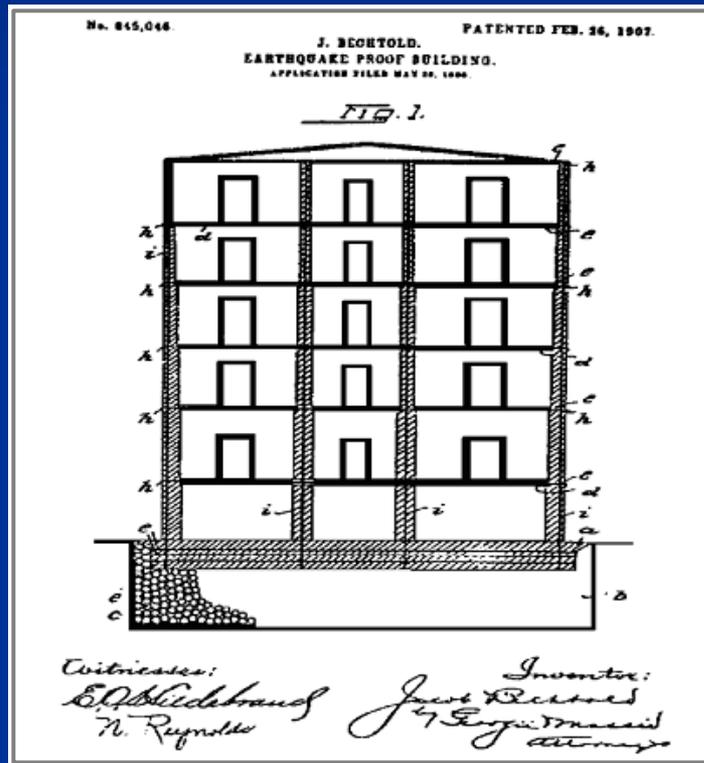
Brevetto per struttura sismoresistente con piastra poggiata su corpi sferici di materiale rigido
