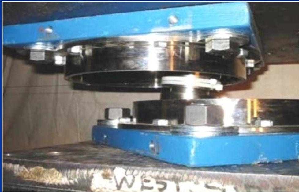
Configurazione spostata di un isolatore a scorrimento
