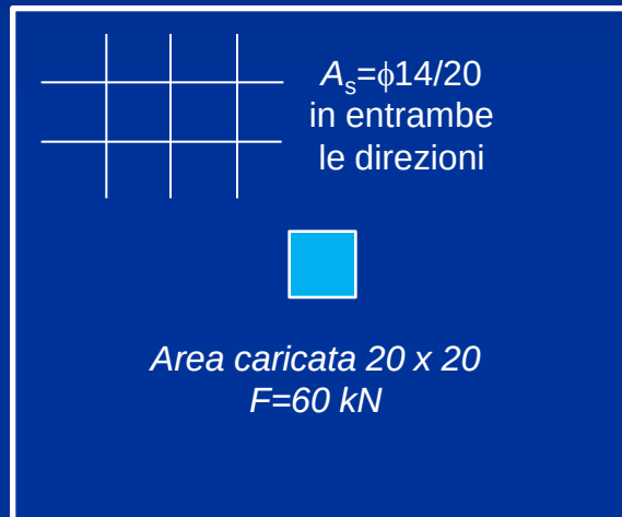
Pianta del solaio
