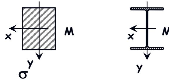
➤ e supponiamo che il comportamento dell'acciaio sia schematizzabile come elastico perfettamente plastico
