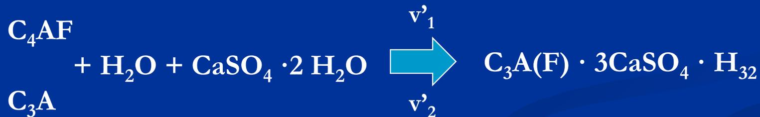
La presenza di gesso o anidrite modifica non solo la velocità di reazione degli alluminati ( $v'_1 < v_1$ ;  $v'_2 < v_2$ ) ma anche il prodotto della reazione, ovvero l'ettringite anziché il C-A-H.
