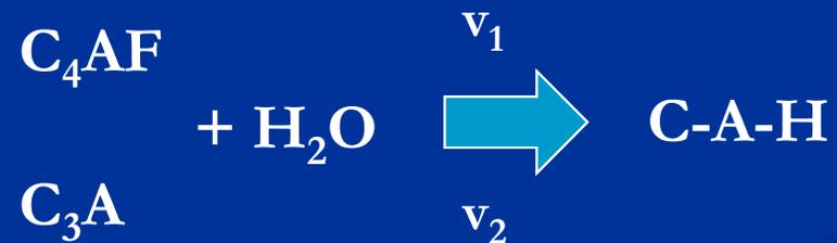
Il  $\text{C}_4\text{AF}$  e soprattutto il  $\text{C}_3\text{A}$  reagiscono rapidamente con l'acqua senza tuttavia contribuire significativamente allo sviluppo della resistenza meccanica se si eccettua un rapido ma piccolo incremento durante le prime ore.
