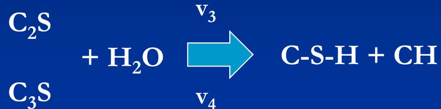
Dei due prodotti solo il C-S-H è determinante per l'indurimento, mentre la calce contribuisce in modo trascurabile a questo processo. Il C-S-H, ancorché si presenti in forme particellari diverse, è di natura prevalentemente fibrosa. Con il progredire della reazione, le fibre del C-S-H formatesi sui granuli di  $\text{C}_3\text{S}$  e  $\text{C}_2\text{S}$  adiacenti, prima si toccano e poi si intrecciano tra loro.
