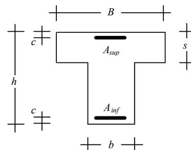
Ricorda che per una sezione rettangolare al secondo stadio la distanza dell'asse neutro dal bordo compresso può essere determinata risolvendo la seguente equazione
