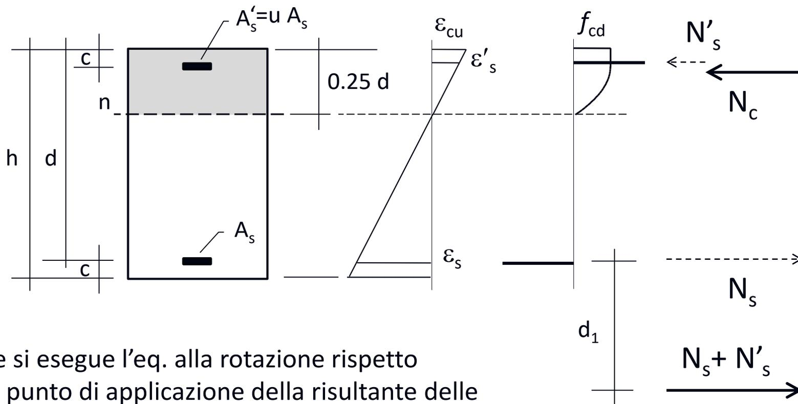
Se si esegue l'eq. alla rotazione rispetto al punto di applicazione della risultante delle tensioni del calcestruzzo, si ha:
