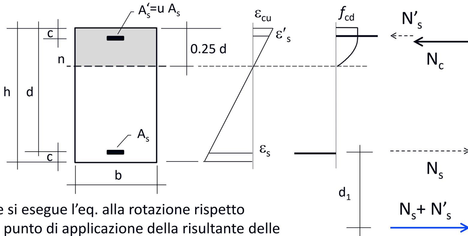
Se si esegue l'eq. alla rotazione rispetto al punto di applicazione della risultante delle tensioni delle armature, si ha:
