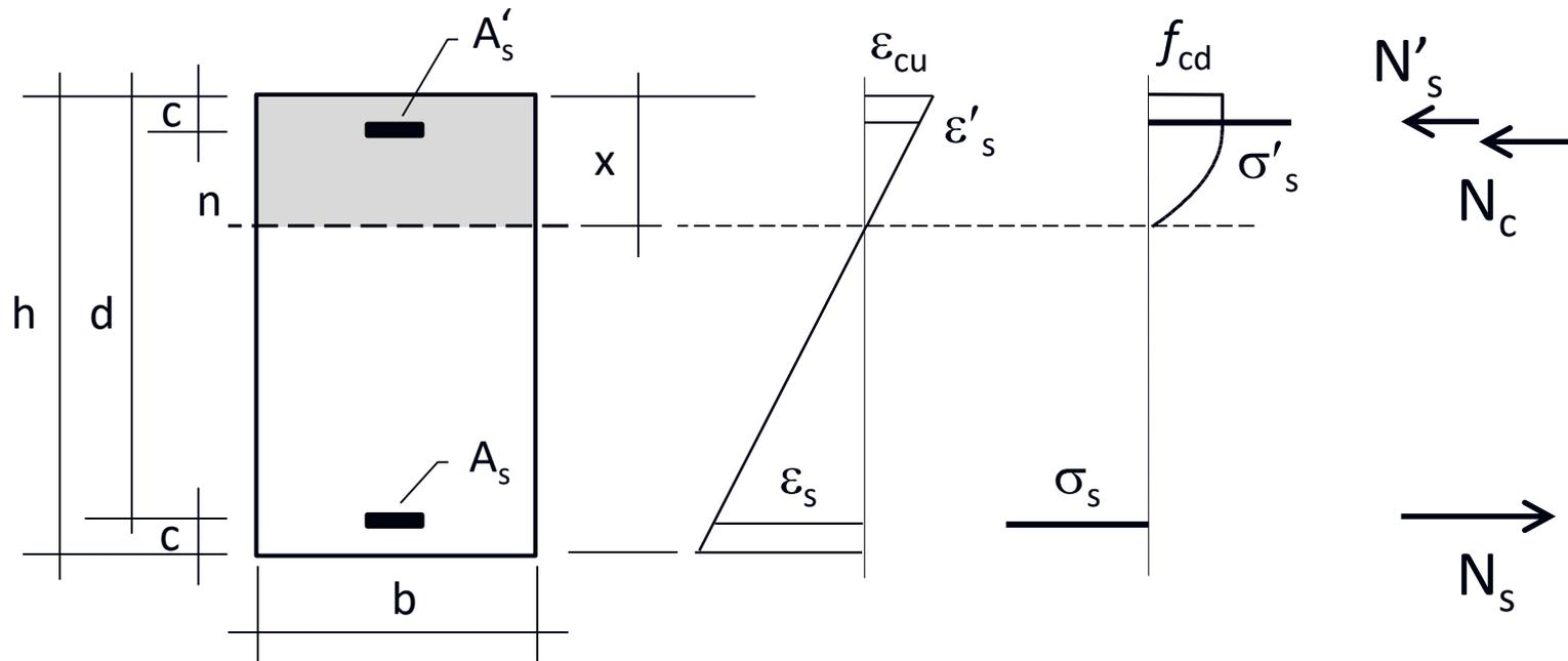
Per trovare l'asse neutro corrispondente al momento resistente, impongo che la deformazione sia pari ad  $\varepsilon_{cu}$  in corrispondenza della fibra compressa più esterna
