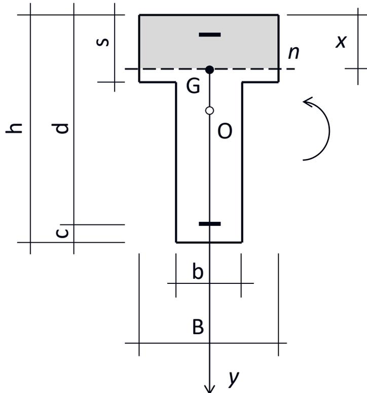
In presenza di una sezione rettangolare a tratti si può fare inizialmente l'ipotesi che la parte compressa sia rettangolare (ovvero, nel caso in figura, che l'asse neutro tagli l'ala).
