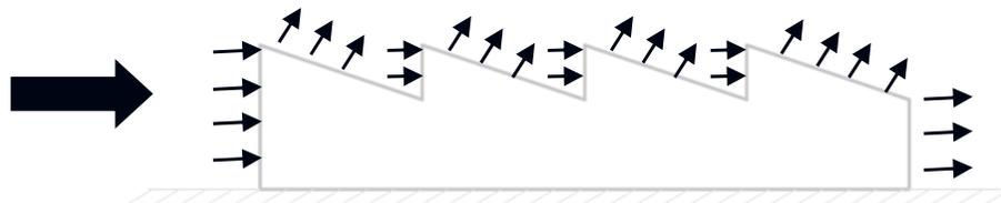
Riduzione del 25% del  $c_{pe}$  del secondo spiovente sopravvento
