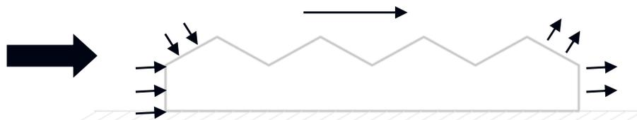
Si applicano al primo e all'ultimo spiovente le pressioni valutate per edifici singoli
