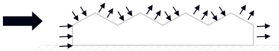
Riduzione del 25% del  $c_{pe}$  di entrambi gli spioventi delle coperture successive
