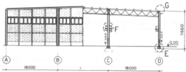
Copertura a doppia falda con inclinazione di  $4^\circ$
