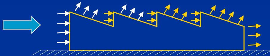
Riduzione del 25% del  $c_{pe}$  del secondo spiovente sopravvento
