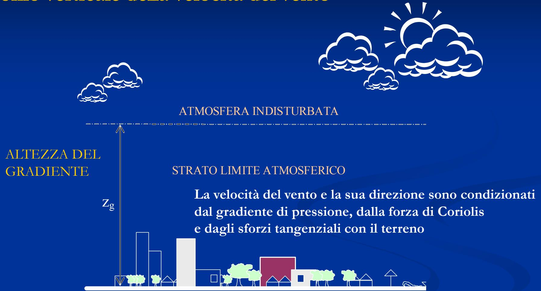
L'altezza del gradiente dipende dalla scabrezza del suolo espressa dal parametro  $z_0$  detto **LUNGHEZZA DI RUGOSITÀ**
