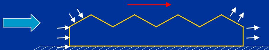
Si applicano al primo e all'ultimo spiovente le pressioni valutate per edifici singoli
